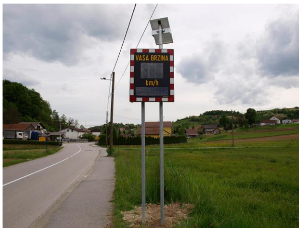
postavljen u solarnoj izvedbi
